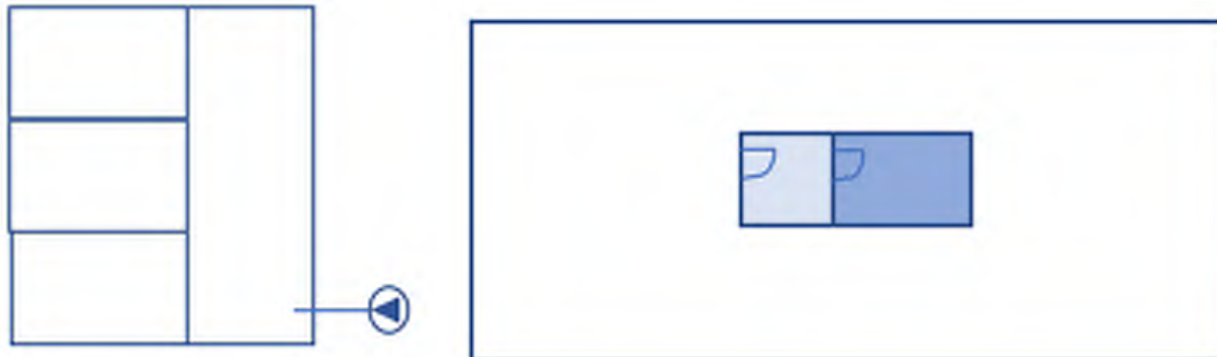
Figur 14: Typsektion och typplan för trycksättning utan krav på flöde över öppen dörr.
