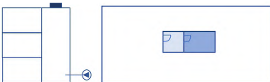
Figur 16. Typsektion och typplan för trycksättning med motviktsspjäll. Placering av motviktsspjäll är markerad med blå fyrkant.
